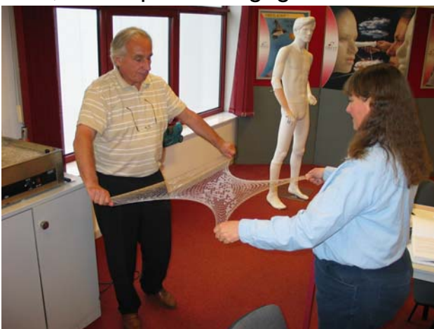
Figur 1 Her demonstreres elasticitet i materiale - materialet udtrækkes maksimalt
